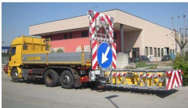
Figura 17: esempio di assorbitore d'urto abbinato al segnale mobile di protezione Fig. Il 401 Art.39 Reg.
