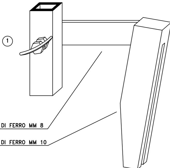
① DISPOSITIVO DI BLOCCAGGIO COMPOSTO DA BULLONE CON GALLETTO
