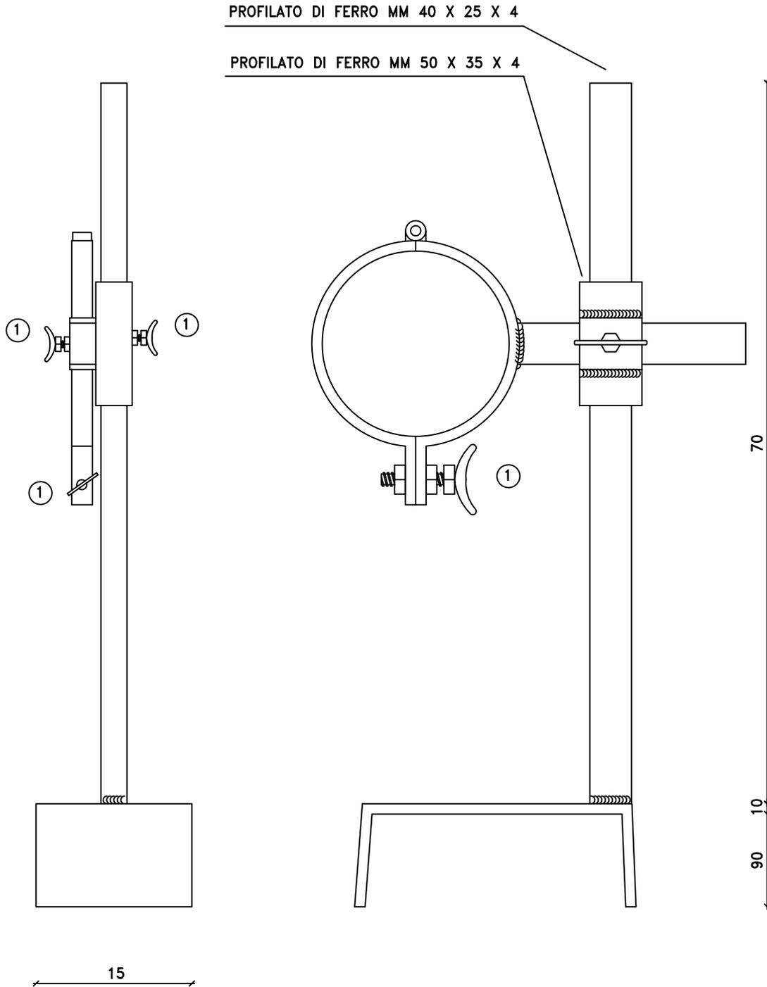
① DISPOSITIVO DI BLOCCAGGIO COMPOSTO DA BULLONE CON GALLETTO
